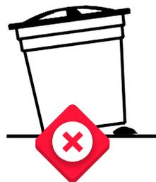
En ningún caso el tanque debe ser apoyado sobre bases que transmitan cargas puntuales como ladrillos, piedras o tablones.
